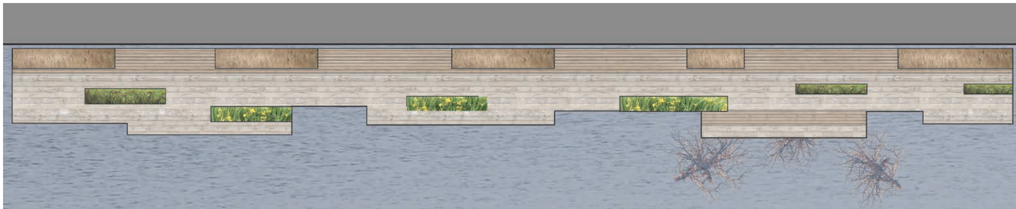
Figuur 3.7. Bovenaanzicht boardwalk met verdiepte bak, dood hout in de omgeving en verschillende plantenbakken met trappsgewijze oeverbeplanting.
